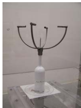
Met One 50.5 Met One Instruments Analog Output Solid blockage = 2.9%
